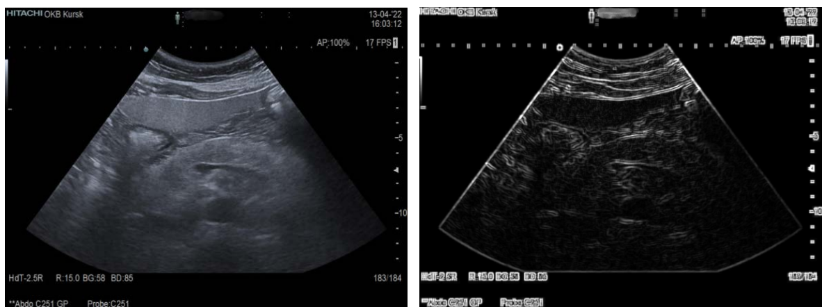
Рис. 8. – УЗ-изображение брюшной полости: а) – исходное изображение, б) – результат работы детектора краев
