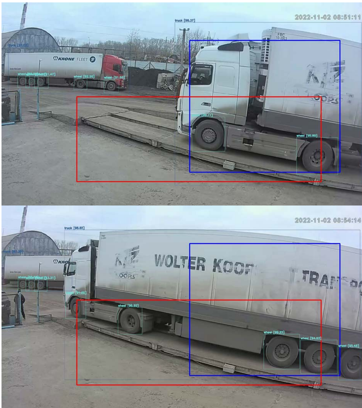
Рис. 2. Пример работы детекции объектов на изображении с помощью модели YOLO
